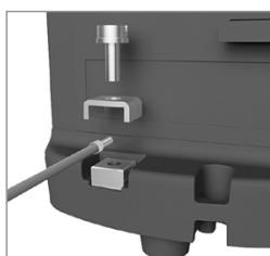
Förbind vågen med en potentialutjämningskabel på minst  $4 \text{ mm}^2$  tvärsnitt med potentialutjämningen.
