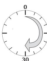
Um genaue Resultate zu liefern, benötigt die Waage eine Anwärmzeit von mindestens 30 Minuten nach erstmaligem Anschluss an die Spannungsversorgung. Erst dann hat das Gerät die notwendige Betriebstemperatur erreicht.
