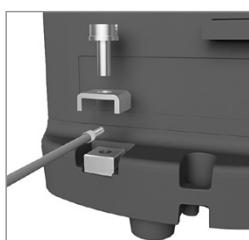
Conecte la balanza a la compensación de potencial utilizando un cable de compensación de potencial con una sección mínima de 4 mm<sup>2</sup>.
