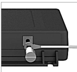
Conecte el convertidor Ex-Link a la compensación de potencial utilizando un segundo cable de compensación de potencial con una sección mínima de 4 mm<sup>2</sup>.
