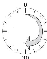
För att kunna visa exakta resultat måste vågen värmas upp i minst 30 minuter efter anslutning till strömförserjningen. Först då har enheten uppnått den nödvändiga drifttemperaturen.
