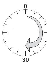
Para obtener resultados exactos, la balanza necesita un tiempo de precalentamiento mínimo de 30 minutos después de conectarla por primera vez al suministro de corriente.
