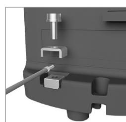
Verbinden Sie die Waage mit einem Potenzialausgleichskabel von mindestens 4 mm<sup>2</sup> Querschnitt mit dem Potenzialausgleich.
