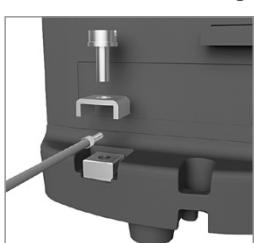
Connectez la balance à la borne d'équipotentialité à l'aide d'un câble d'équipotentialité d'au moins 4 mm<sup>2</sup> de section transversale.
