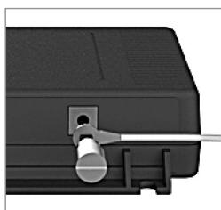
Förbind Ex-Link-konvertern med ytterligare en potentialutjämningskabel på minst  $4 \text{ mm}^2$  tvärsnitt med potentialutjämningen.
