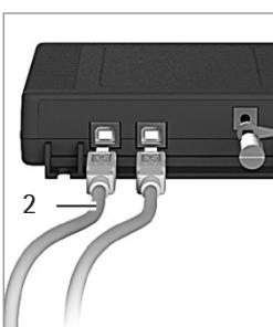
**Anschluss an Netzgerät (optional); nicht beim YCO14-Y, wenn dieser im explosionsgefährdeten Bereich der Zone 2 oder Division 2 installiert ist**
