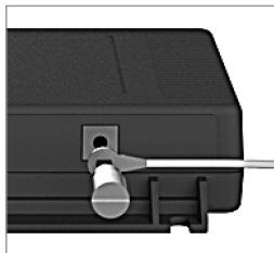
Connectez le convertisseur de jonction antidéflagrant à la borne d'équipotentialité à l'aide d'un autre câble d'équipotentialité d'au moins 4 mm<sup>2</sup> de section transversale.
