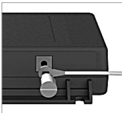
Verbinden Sie den Ex-Link Konverter mit einem weiteren Potenzialausgleichskabel von mindestens 4 mm<sup>2</sup> Querschnitt mit dem Potenzialausgleich.
