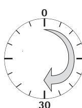
Après le premier raccordement au secteur, la balance a besoin d'un temps de préchauffage d'au moins 30 minutes afin de pouvoir fournir des résultats précis. L'appareil atteint alors la température nécessaire à son bon fonctionnement.
