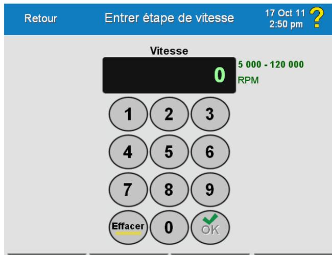
Les valeurs acceptables pour la vitesse sont affichées à droite dans le champ d'affichage : de 5 000 à 120 000 tr/min en fonction du rotor sélectionné.
