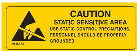
Verweist auf einen Bereich im Instrument, der empfindlich gegen elektrostatische Aufladung (ESD) ist. Um Schäden durch elektrostatische Entladung zu verhindern, immer ein ordnungsgemäß geerdetes Handgelenkband bei der Arbeit mit dem Gerät tragen. Detaillierte Informationen zur ordnungsgemäßen Erdung entnehmen Sie dem IEEE-Standard P1100.
