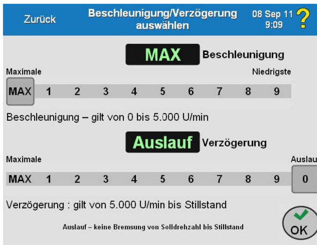
Wird als Verzögerungsrate der Wert für den ungebremsten Auslauf ausgewählt, wird das Wort „Coast“ (Auslauf) im Feld „Time“ (Zeit) angezeigt.
