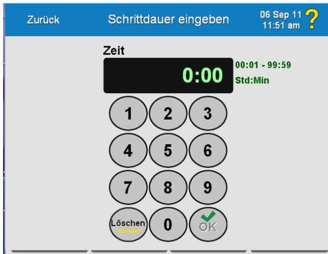
Die zulässigen Werte für die Laufzeit werden rechts neben dem Anzeigefeld eingeblendet: von 00:01 bis 99:59 HH:MM.
