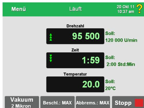
Wenn die Anzeige „Time“ (Zeit) den Wert Null erreicht hat, endet der Lauf automatisch, und ein Signalton wird ausgegeben.
