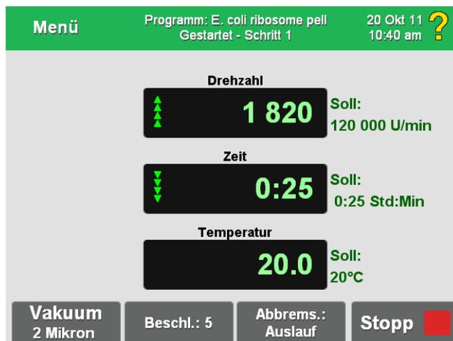
Diese Anzeige wird ständig aktualisiert, um den aktuellen Status jedes Programmschritts anzugeben.
