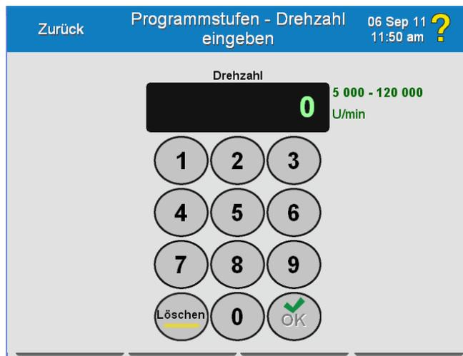
Die zulässigen Laufdrehzahlwerte werden rechts neben dem Anzeigefeld eingeblendet: von 5 000 bis 120 000 U/min, je nach ausgewähltem Rotor.
