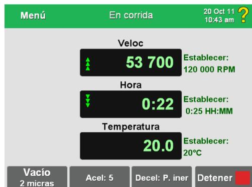
La carrera terminará automáticamente cuando el indicador Time (Hora) llegue a cero; se emitirá un pitido.
