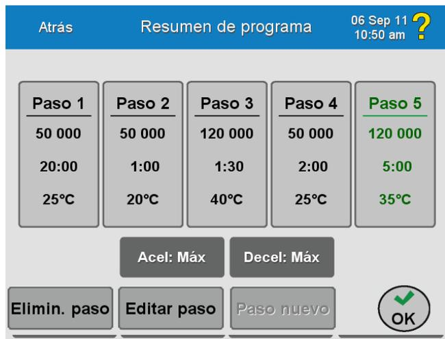
El valor de aceleración se utiliza en el primer paso del programa y el valor de deceleración se utiliza en el último paso del programa.
