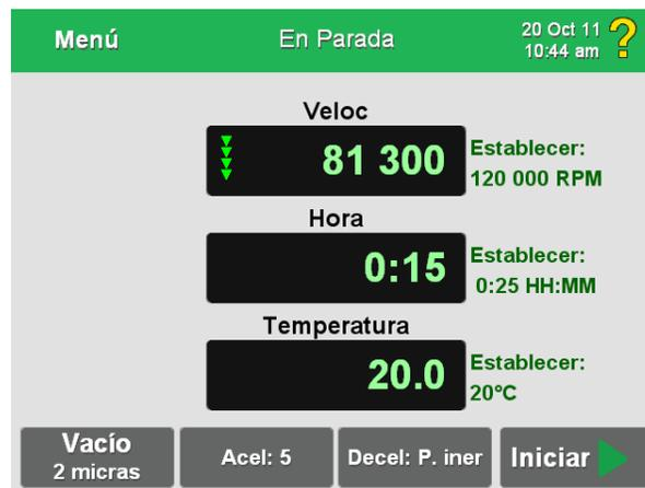
**2** Cuando la carrera se detiene y el tiempo llega a **0**, se puede pulsar el botón **VACUUM** (VACÍO) para apagar el sistema de vacío y ventilar el vacío.
