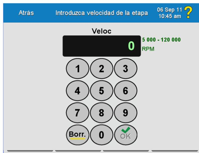
Los valores aceptables de velocidad de carrera se muestran a la derecha del campo indicador: de 5000 a 120 000 RPM, según el rotor seleccionado.
