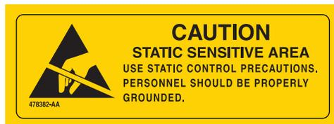
Indica un área del instrumento sensible a descargas electrostáticas (ESD). Para evitar daños debido a descargas electrostáticas, lleve siempre una pulsera electrostática propiamente conectada a tierra mientras trabaja con este instrumento. Para obtener más detalles sobre la conexión a tierra, consulte el estándar P1100 del IEEE.
