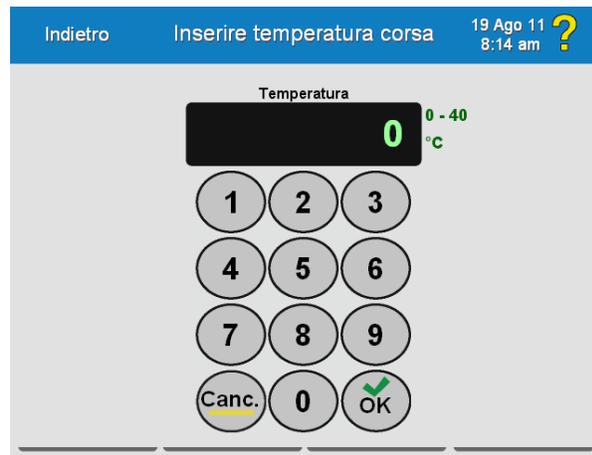
I valori accettabili per la temperatura della corsa vengono mostrati a destra del campo del display: da 0 a 40 °C.
