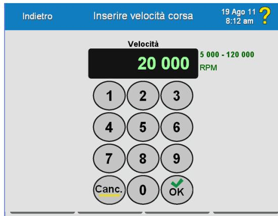
I valori accettabili per la velocità vengono mostrati a destra del campo del display: da 5.000 a 120.000 giri/min.
