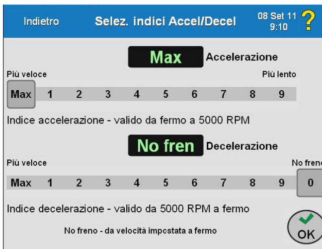
Se viene selezionato un valore di decelerazione senza frenatura, nel campo Time (Tempo) viene visualizzato “Coast” (No fren).
