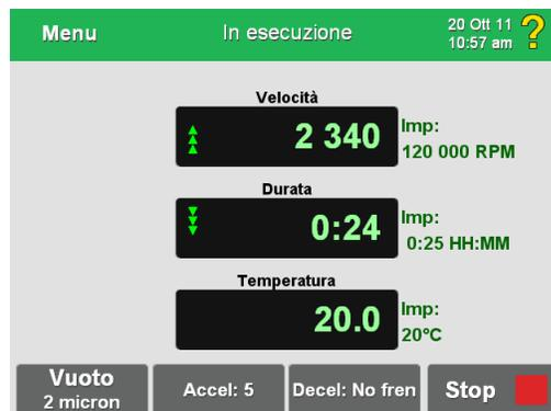
La centrifugazione si arresta automaticamente quando il display Time (Tempo) raggiunge lo zero e viene emesso un segnale acustico.
