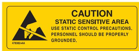
Indica un'area dello strumento sensibile alle scariche elettrostatiche (ESD). Al fine di evitare i danni dovuti a scariche elettrostatiche, indossare sempre un cinturino di messa a terra durante l'utilizzo dello strumento. Per dettagli sulla messa a terra adeguata, consultare lo standard IEEE P1100.
