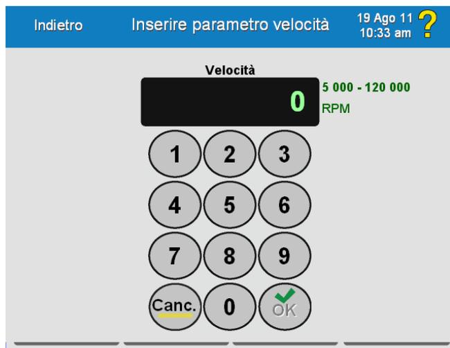
I valori accettabili per la velocità di corsa vengono mostrati a destra del campo di visualizzazione: da 5.000 a 120.000 giri/min, a seconda del rotore selezionato.
