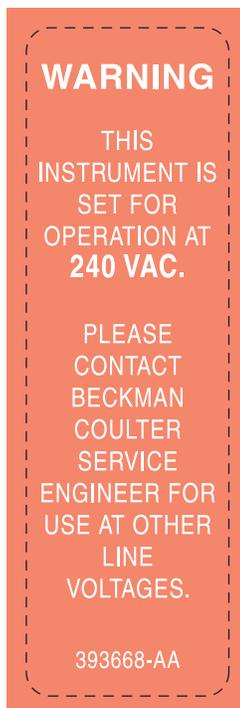
このシンボルマークは装置が240 VACで動作する構成になっていることを示します。他のライン電圧で使用するためにはBeckman Coulterのサービス技術者にお問い合わせください。
