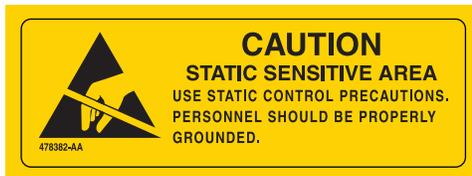
静電気放電(ESD)に敏感な機器のエリアを示します。静電気放電による損傷を防ぐため、本装置の操作中は常に適切に接地されたりリストストラップを着用してください。正しい接地の詳細は、IEEE 標準 P1100を参照してください
