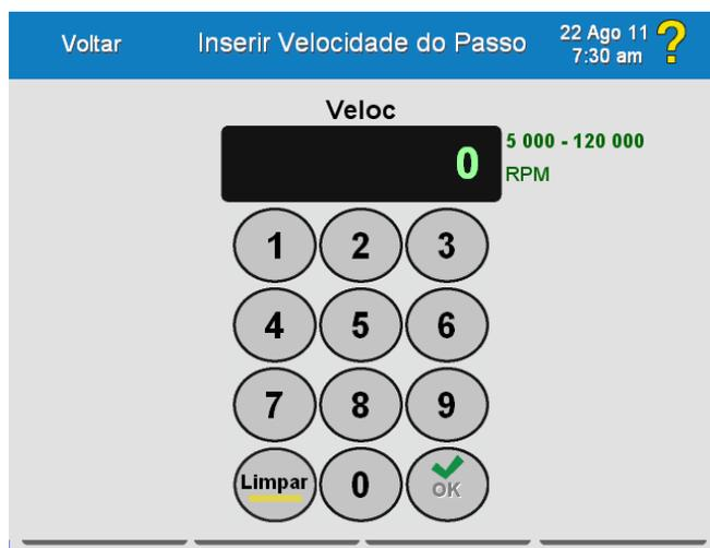
Os valores aceitáveis para a velocidade da execução são mostrados à direita do campo do visor: de 5.000 a 120.000 RPM, dependendo do rotor selecionado.
