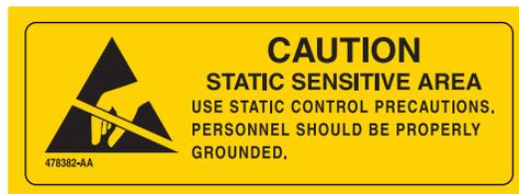
Indica uma área do instrumento que é sensível a descargas eletrostáticas (ESD). Para impedir danos causados por descarga eletrostática, sempre use uma pulseira devidamente aterrada ao operar esse instrumento. Para obter mais detalhes sobre o aterramento correto, consulte a norma P1100 do IEEE.
