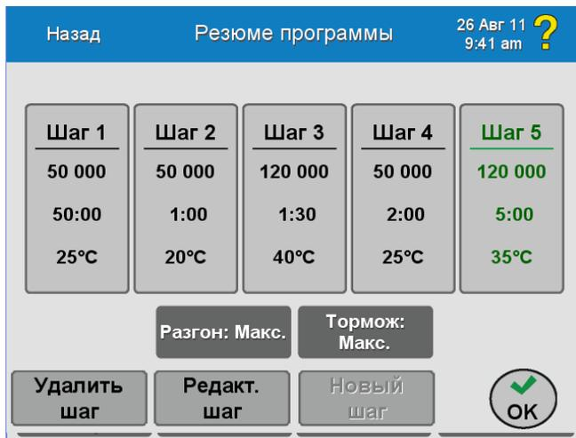
Отображаемое значение разгона относится к первому шагу программы, а значение торможения – к последнему шагу.
