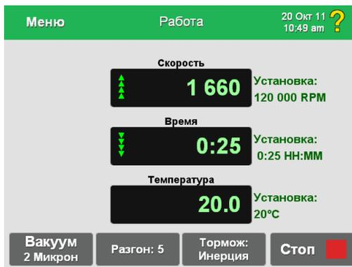
Когда обратный отсчет времени в поле Time (Время) достигает нуля, центрифугирование останавливается автоматически и звучит тональный звуковой сигнал.
