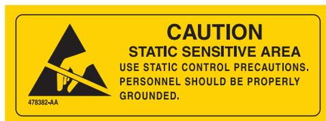
Указывается область прибора, чувствительная к электростатическому разряду (ESD). Чтобы не допустить выхода из строя от электростатического разряда при эксплуатации прибора всегда одевайте хорошо заземленный антистатический браслет. Как правильно выполнить заземление, см. стандарт IEEE P1100.
