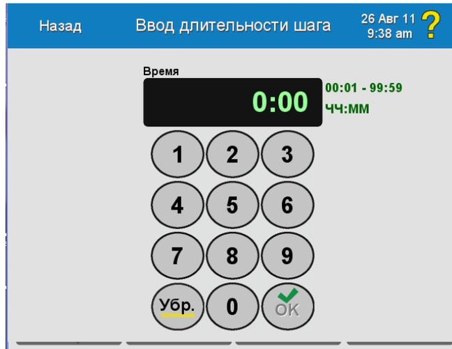
Приемлемые значения длительности шага выводятся справа от поля отображения параметра: от 00:01 до 99:59 НН:ММ (ЧЧ:ММ).
