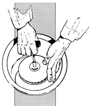
**ПРИМЕЧАНИЕ** Если в ротор с фиксированным углом помещаются длинные пробирки, крышку ротора можно снять.
