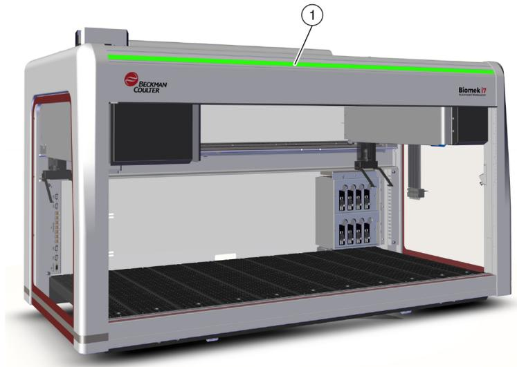
1. Die Leiste mit Statusanzeigeleuchten ist an der Front des Geräts sichtbar.
