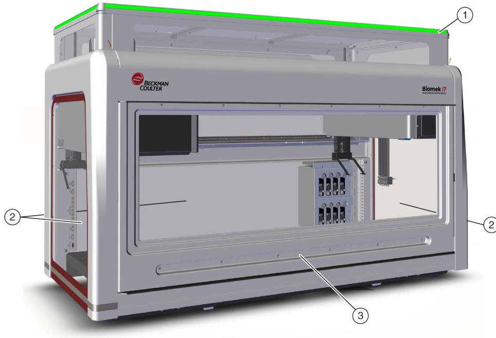
1. Strahlenkranz mit Leiste für Statusanzeigeleuchten
