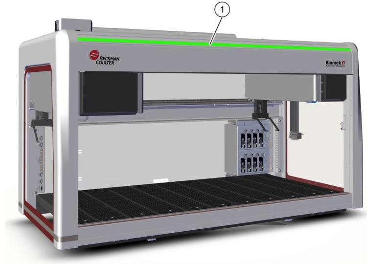
1. La barra para luces indicadoras de estado está visible en la parte frontal del instrumento.
