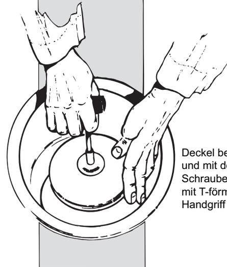
Abbildung 3-1. Installation des Rotors
