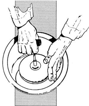
**NOTA** Os rotores de ângulo fixo podem ser centrifugados sem tampas colocadas quando são utilizados tubos mais compridos.
