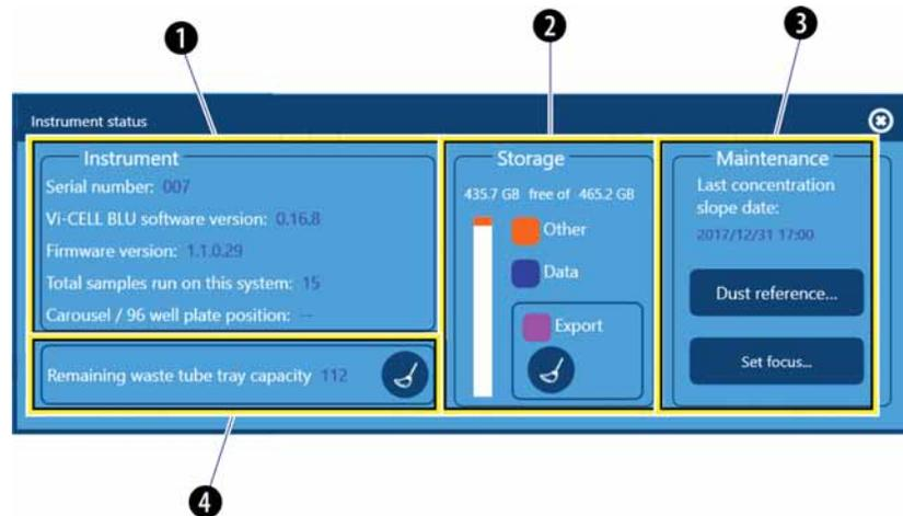
1. **Instrument.** Affiche les informations relatives à l'instrument, notamment le numéro de série, la version logicielle, la version du micrologiciel, le nombre total d'analyses d'échantillons sur le système et la position du carrousel / de la plaque de 96 puits.
