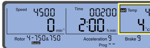
**HINWEIS** Um Temperaturen über der Umgebungstemperatur zu erreichen, benötigt die Zentrifuge die Reibungswärme, die während des Betriebs im Inneren der Kammer erzeugt wird. Bei geringen Durchlaufdrehzahlen oder niedrigen Umgebungstemperaturen kann die Zentrifuge möglicherweise keine höheren Temperaturen erreichen.
