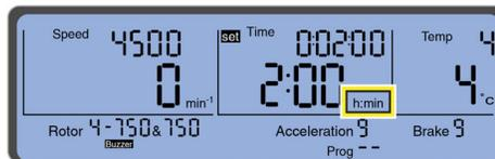
Der Parameter „Time“ (Zeit) kann während der Zentrifugation geändert werden.
