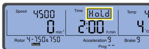
**3** Disattivare il ciclo in modalità **HoLd** (Continua) premendo il pulsante **STOP** (ARRESTO).
