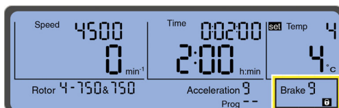
Рисунок 2.14 Символ «Замочек» указывает активированную блокировку настроек
