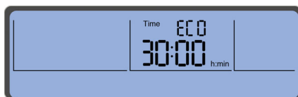
Рисунок 2.9 Пример режима ECO (Экономичный), установленного на 30 минут
