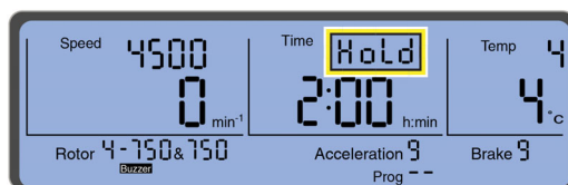
Figura 2.5 Indicación «HoLd» durante un proceso permanente
