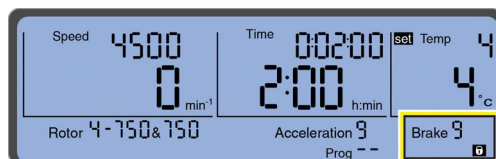
Figura 2.14 El símbolo del candado indica que se ha activado un bloqueo de los ajustes
