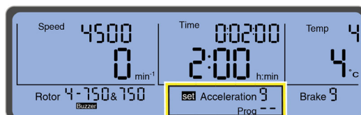
Figura 2.12 Ejemplo de preselección de un perfil de aceleración
