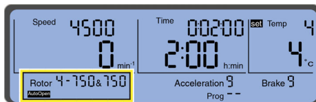
Figura 2.15 La función de apertura automática de la puerta «AutoOpen» está activada
