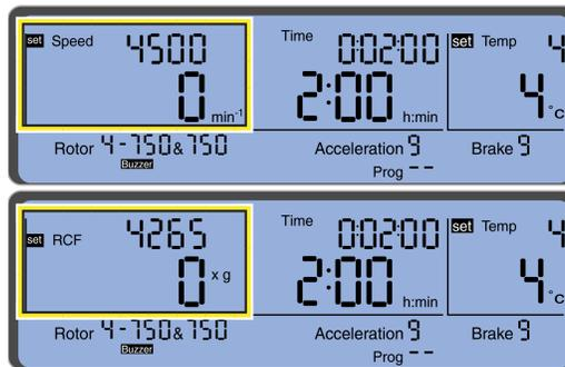
Die Parameter „Speed“ (Drehzahl) und „RCF“ (RZB) können während des Zentrifugationslaufs geändert werden.
