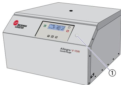
1. Öffnung für Deckelnotfallentriegelung
