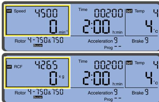
I parametri velocità e RCF possono essere modificati nel corso del ciclo di centrifugazione.
