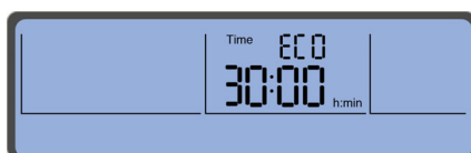
Figura 2.9 Ejemplo de modo ECO configurado en 30 minutos
