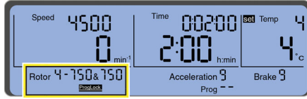
Şekil 2.19 Program kilidi “ProgLock” etkinleştirilmiş
