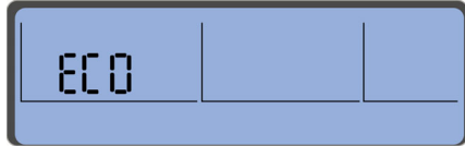
Şekil 2.11 ECO (EKO) Modu zamanlayıcısının süresi bittiğinde
