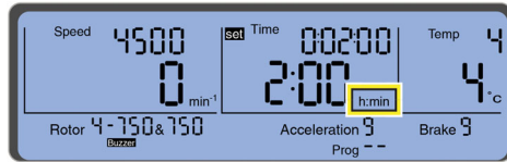
Şekil 2.4 Sürenin ayarlanması (burada “sa:dak” birimi olarak gösterilmektedir)
