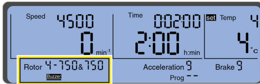
Şekil 2.16 Sesli sinyal Buzzer (Zil) etkinleştirilmiş
