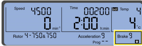
Şekil 2.14 Ayar kilidinin etkinleştirildiğini gösteren “Kilit” sembolü
