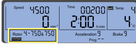
Şekil 2.15 Otomatik kapı açma işlevi “Auto Open” etkinleştirilmiş
