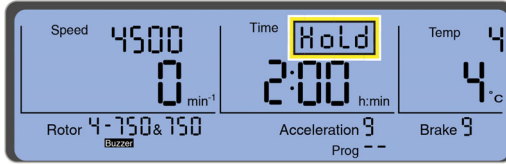
Şekil 2.5 Hold (Bekletmeli) Çalışma sırasında görüntülenen “HoLd” (“Bekletmeli”) ifadesi
