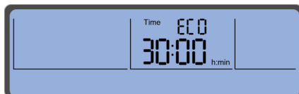
Afbeelding 2.9 Voorbeeld van de modus ECO (ECO) ingesteld op 30 minuten
