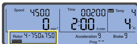
Afbeelding 2.15 De automatische deuropeningsfunctie “Auto Open” is geactiveerd.
