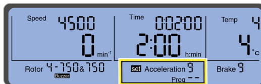
Afbeelding 2.12 Voorbeeld voorselectie van een acceleratieprofiel
