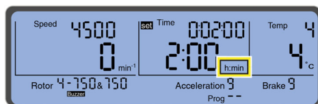
Afbeelding 2.4 Instellen van de tijd (hier weergegeven in de tijdseenheid "h:min")
