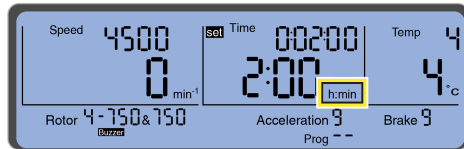
그림 2.4 시간 설정(여기서 시간 단위 “h:min”으로 표시)
