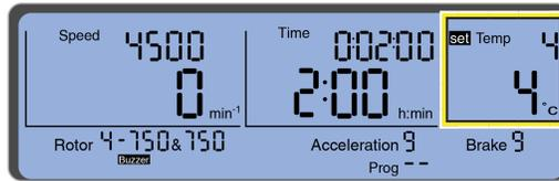
**NOTA** Para alcançar temperaturas acima da temperatura do ambiente, a centrífuga depende do calor de fricção gerado dentro da câmara durante a operação. Em baixas velocidades de processamento ou baixas temperaturas ambientes, a centrífuga pode não conseguir alcançar algumas temperaturas mais altas.
