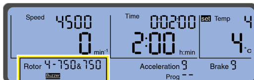
Obrázek 2.16 Zvukový signalizační bzučák je aktivovaný
