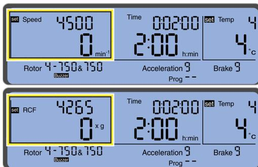
Os parâmetros speed (velocidade) e RCF (RCF) podem ser alterados durante o processamento de centrifugação.
