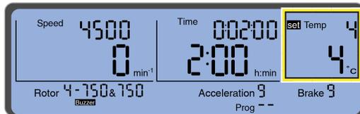
**NOTA** Para alcançar temperaturas acima da temperatura do ambiente, a centrífuga depende do calor de fricção gerado dentro da câmara durante a operação. Em baixas velocidades de processamento ou baixas temperaturas ambientes, a centrífuga pode não conseguir alcançar algumas temperaturas mais altas.
