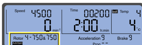
Obrázek 2.15 Funkce „automatické otevírání“ pro automatické otevírání dvířek je aktivovaná
