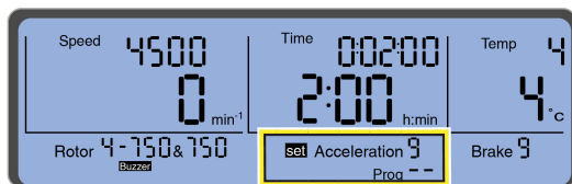
Obrázek 2.12 Příklad předběžného výběru profilu zrychlení
