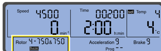
Obrázek 2.16 Zvukový signalizační bzučák je aktivovaný
