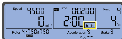
Obrázek 2.4 Nastavení času (zde zobrazeny jednotky času v „hod./min.“)
