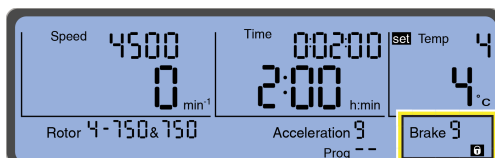
Obrázek 2.14 Symbol visacího zámku, který značí aktivovaný zámek nastavení
