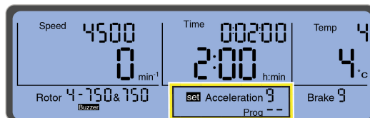
Figur 2.12 Eksempel på forvalg af en accelerationsprofil
