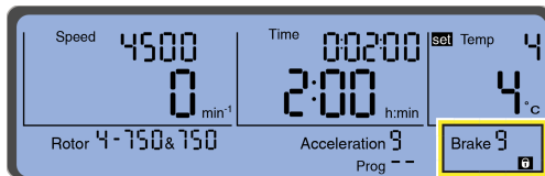
Figur 2.14 Hængelåssymbolet, der angiver, at indstillingslåsen er aktiveret
