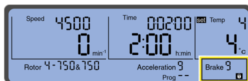
Rysunek 2.14 Symbol „kłódki” oznaczający aktywną blokadę ustawień
