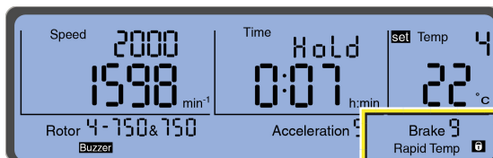
Rysunek 2.8 Program „Rapid Temp” (Szybka regulacja temperatury)
