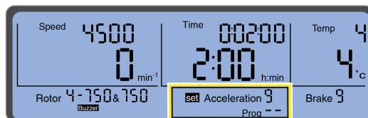
Rysunek 2.12 Przykład wstępnego wyboru profilu przyspieszenia
