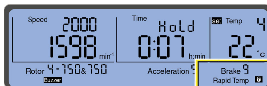
Figura 2.8 Programul „Rapid Temp” (Temperatură rapidă)
