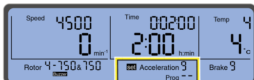
Obrázok 2.12 Príklad voľby profilu zrýchlenia pred použitím
