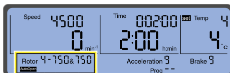
Obrázok 2.15 Aktivovaná funkcia „Auto Open“ (Automatické otvorenie dvierok)
