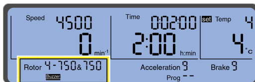
Obrázok 2.16 Aktivovaná funkcia Buzzer (Zvuková signalizácia)
