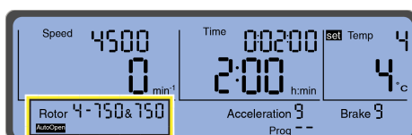
Hình 2.15 Chức năng mở cửa tự động “AutoOpen” được kích hoạt
