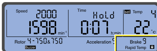
Hình 2.8 Chương trình “Rapid Temp” (Điều chỉnh nhiệt độ nhanh)
