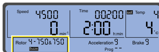
Hình 2.16 Tín hiệu âm thanh khi Buzzer (Chuông báo) được kích hoạt
