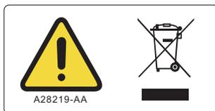
Dieses Symbol wird entsprechend der Richtlinie über Elektro- und Elektronik-Altgeräte der Europäischen Union benötigt. Ist dieses Etikett auf einem Produkt angebracht, wissen Sie:
