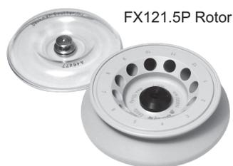
Bei dem Rotor FX121.5P mit einer Nenndrehzahl von 14.800 RPM handelt es sich um einen Festwinkelrotor mit einem Röhrenwinkel von 45° zur Drehachse. Im Rotor FX121.5P können bis zu 12 Reaktionsröhren mit einem Volumen von je 1,5 bis 2,2 ml bzw. von je 200 bis 750 µl (bei Einsatz von Adaptern) zentrifugiert werden
