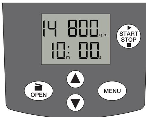
Eine zweimalige Betätigung der Taste **MENU** aktiviert den RCF-Bearbeitungsmodus (zur Einstellung der relativen Zentrifugalkraft). In diesem Fall blinkt **xg** in der Anzeige. Die RPM-Einstellung wird mit der Aufwärts- oder Abwärts-Pfeiltaste in Schritten von  $10 \times g$  vorgenommen.
