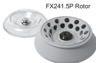
RPM ist ein Festwinkelrotor mit zwei konzentrischen Ringen aus jeweils zwölf Röhrenpositionen. Der Röhrenwinkel im äußeren Ring beträgt 32 Grad, während der Röhrenwinkel im inneren Ring 53 Grad beträgt. Durch dieses einzigartige Design werden die Proben in beiden Ringen derselben maximalen Zentrifugalkraft ausgesetzt. Im Rotor FX241.5P können bis zu 24 Reaktionsröhren mit einem Volumen von je 1,5 bis 2,2 ml bzw. von je 200 bis 750 µl (bei Einsatz von Adaptern) zentrifugiert werden.\*
