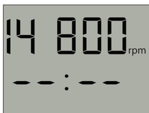
Ein Kurzlauf wird durch Gedrückthalten der Taste **START STOP** gestartet. Der Rotor beschleunigt auf die Höchstdrehzahl, **short run** wird eingeblendet, und die verstrichene Laufzeit in Sekunden wird angezeigt.
