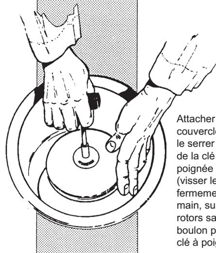
Figure 3-2. Installation d'un rotor
