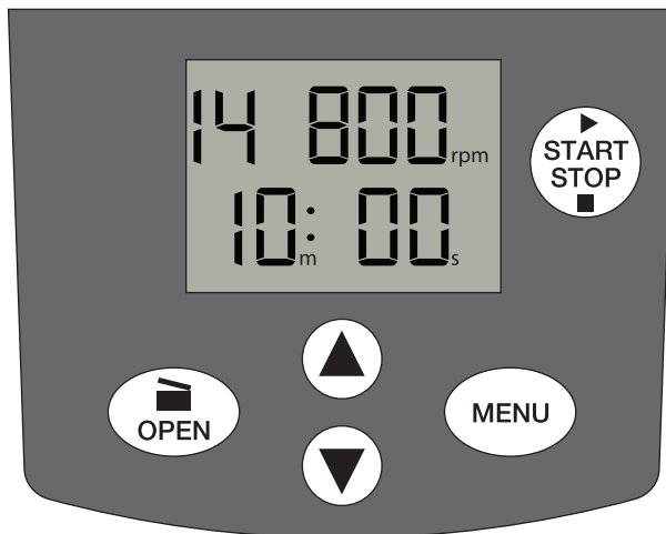
Figura 2.2 El tablero de control
