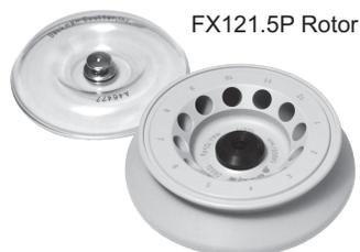
Il rotore FX121.5P, da 14.800 giri/min nominali, è un rotore ad angolo fisso con una inclinazione delle provette di 45 gradi rispetto all'asse di rotazione. Il rotore FX121.5P può centrifugare un massimo di dodici provette di reazione da 1,5 a 2,2 mL, oppure da 200 a 750  $\mu$ L, usando appositi adattatori.\*
