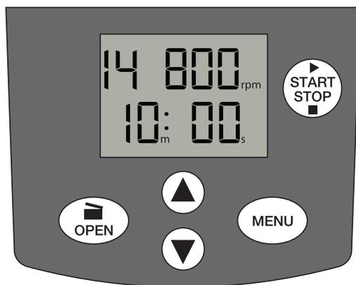
Premendo due volte il tasto **MENU** si attiva la modalità di modifica della RCF (relative centrifugal force o forza centrifuga relativa) ed **xg** lampeggia sul display. Premere il tasto su o giù per regolare l'impostazione rcf, con incrementi di  $10 \times g$ .
